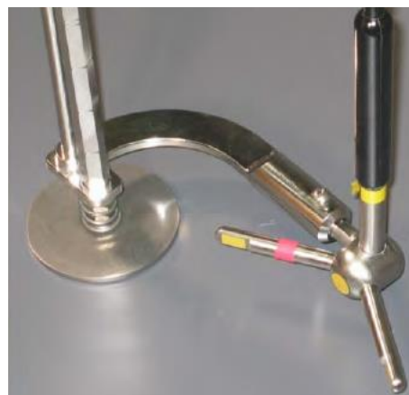
Figura 5-3: sonda ad ultrasuoni del misuratore di portata Sonteck/YSI FlowTracker
