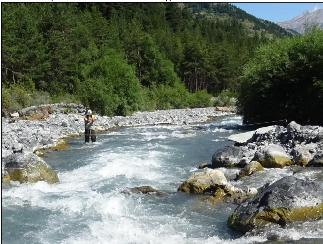
Figura 5-1: misura della portata con correntometro a effetto Doppler
