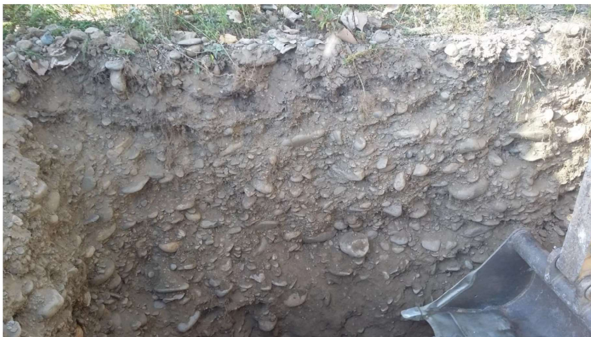
Foto 4. Materiale di riporto ciottoloso ghiaioso con matrice sabbiosa del livello 1.
