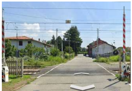
27 - Strada di posa nuova linea con cavo interrato 3x1x240 mmq Al in sostituzione del cavo interrato esistente; l'attraversamento della ferrovia potrà avvenire con tecnica di microtunneling
