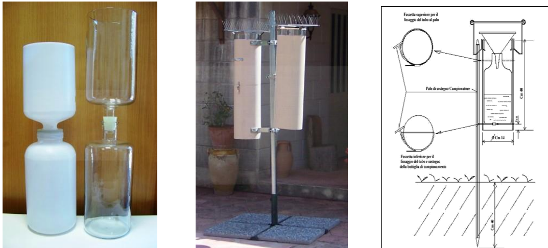
Figura 28 – sistema di raccolta ISTISAN 06/38 - Deposimetro – foto e schema installazione bulk
