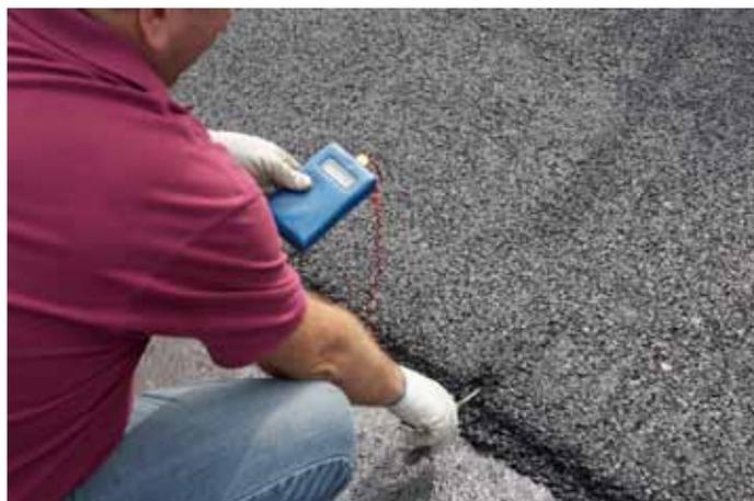
della provincia, ma intanto venerdì 5 settembre alla ditta Sintexcal di Torino hanno avuto luogo le "prove in impianto". L'asfalto sperimentale che è stato utilizzato contiene una percentuale dell'8% di bitume addizionato con polverino,
