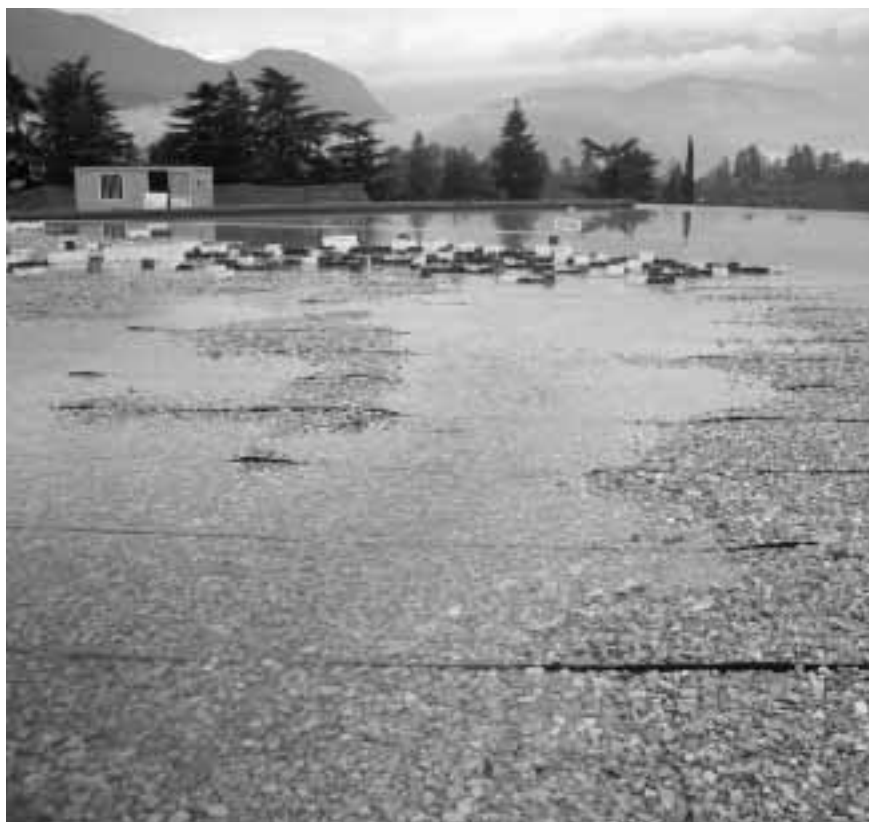
Simulazione alluvione 2000 nel modello fisico del nodo idraulico. Foto AFPT
