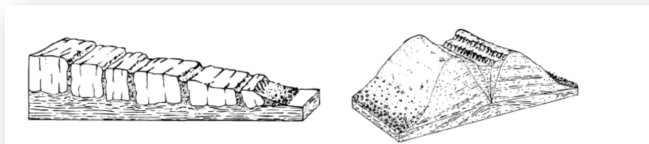
Figura 3-4: i due tipi principali di lateral spread; lateral spread di formazioni fragili sovrastanti unità duttili (a sinistra); lateral spread in rocce omogenee (a destra)
