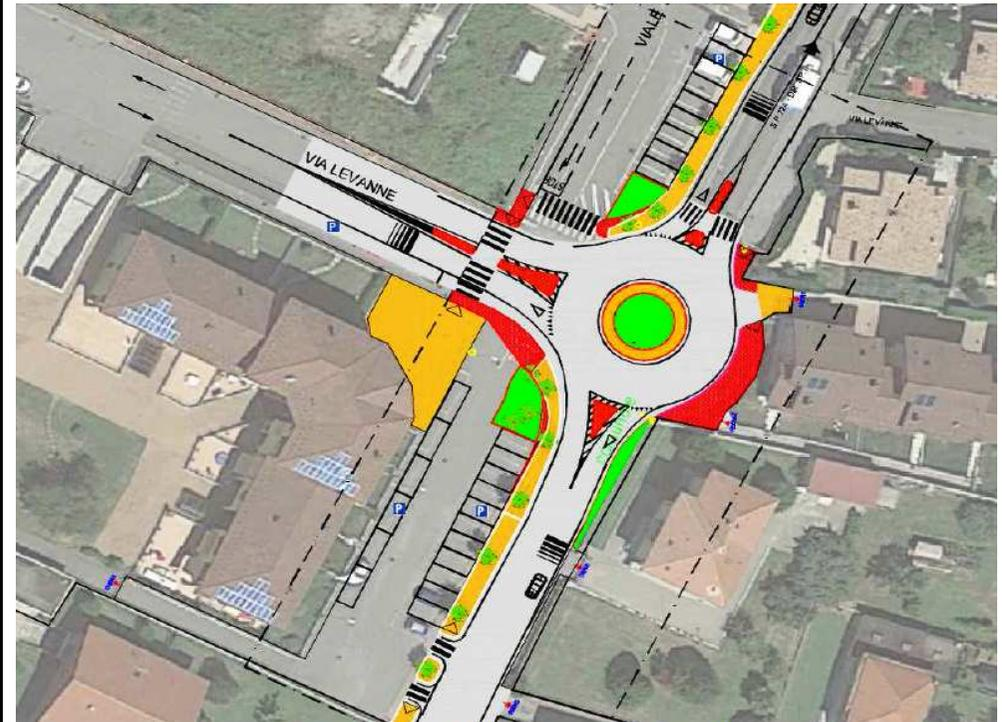
Figura 12 – sistemazione incrocio via Levanne in progetto
