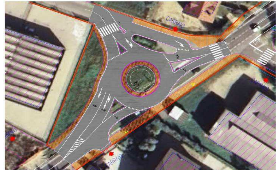
Figura – planimetria d'intervento ipotesi sistemazione a rotondella dell'intersezione sp119 con Via Chieri
