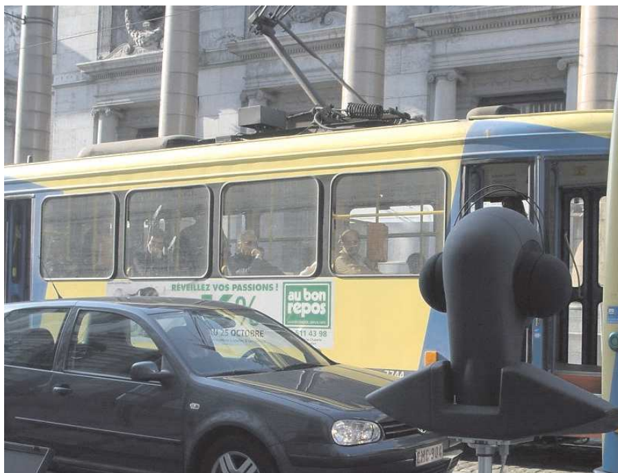
Figura 6: Testa artificiale per registrazioni binaurali
