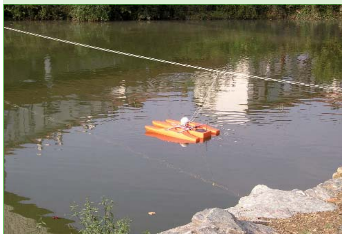
Rilievo del profilo dell'alveo realizzato con trimarani dotati di sensore
