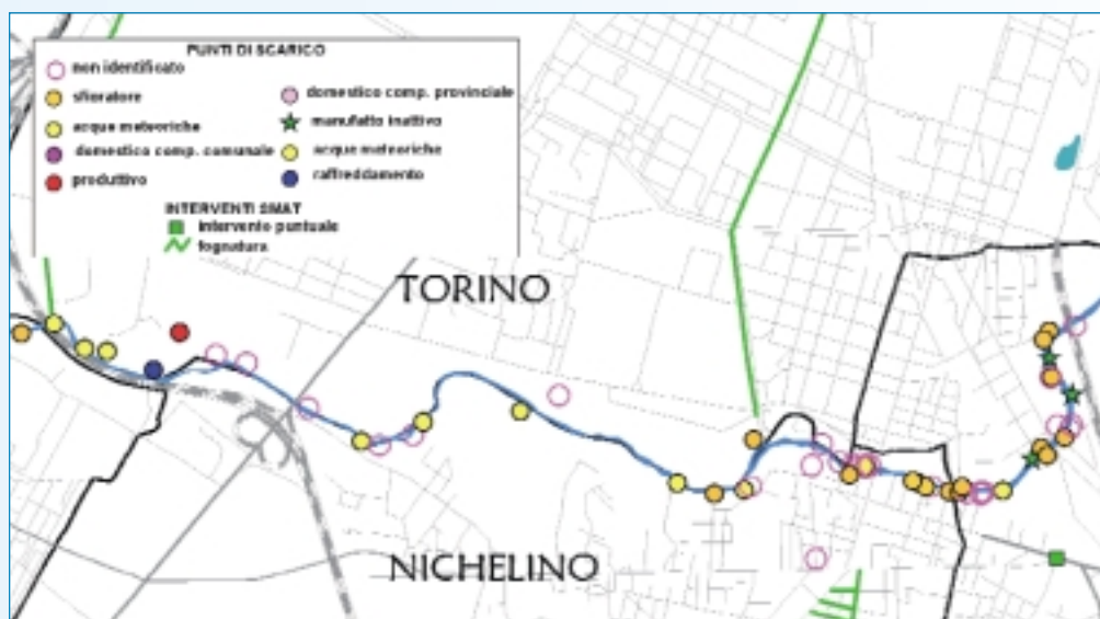
Fig. 26: Dettaglio nuovi tratti di collettori di fognatura intercomunali realizzati da Smat nel territorio del comune di Nichelino
