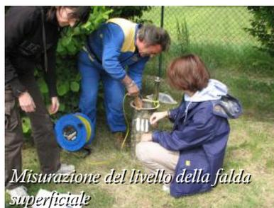
*Misurazione del livello della falda superficiale*
