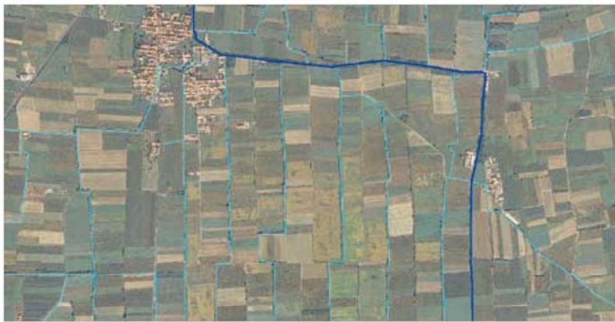
Esempio di rete di distribuzione irrigua: in blu il canale derivatore principale, in azzurro la rete secondaria
