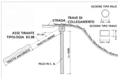
Sezione tipo di consolidamento versante con pali e tiranti
