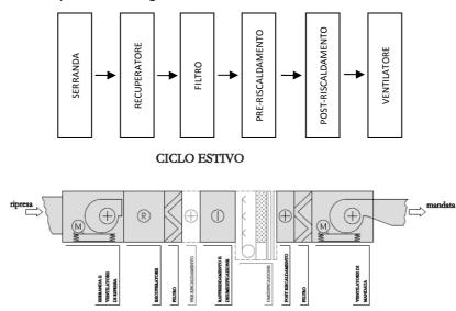
La batteria pre-riscaldamento e la sezione umidificante non sono operative.
