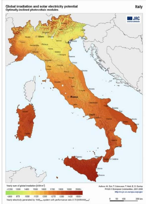
Radiazione incidente sul piano orientato con inclinazione ottimale
