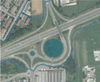
**Figura 1. INSERIMENTO DI BACINI DI RACCOLTA PER L'ACQUA INTERNO AL RACCORDO**
