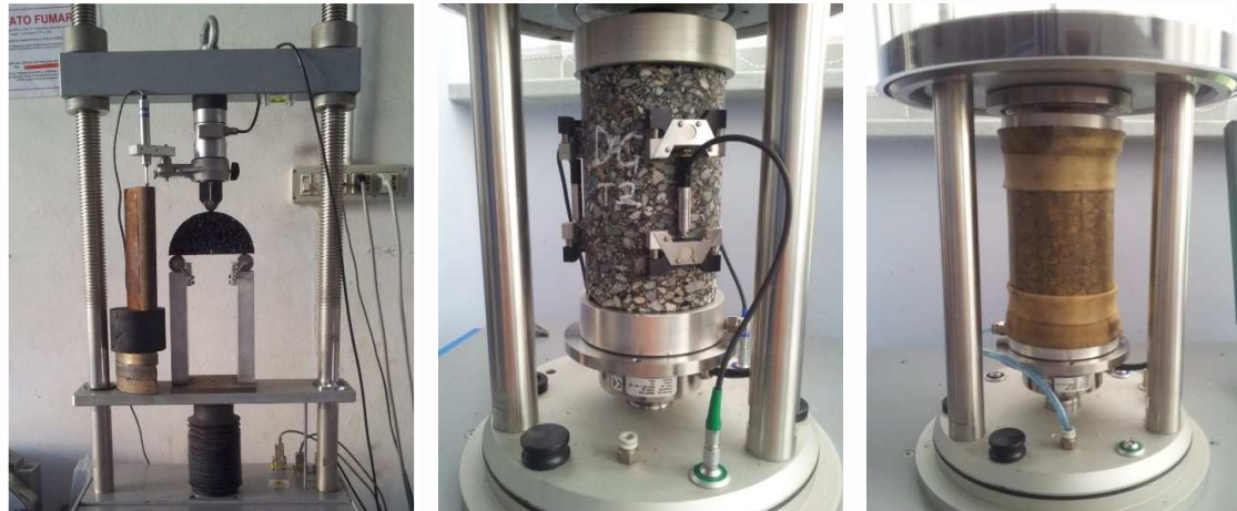
Prove prestazionali sulle miscele bituminose contenenti asphalt rubber
