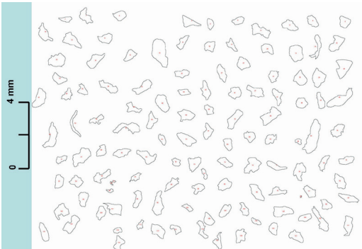
Immagine al microscopio di un campione di polverino da PFU elaborato con algoritmi di analisi delle immagini.
