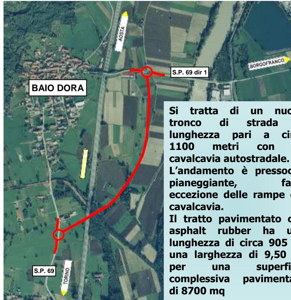
Si tratta di un nuovo tronco di strada di lunghezza pari a circa 1100 metri con un cavalcavia autostradale. L'andamento è pressoché pianeggiante, fatta eccezione delle rampe del cavalcavia. Il tratto pavimentato con asphalt rubber ha una lunghezza di circa 905 m, una larghezza di 9,50 m, per una superficie complessiva pavimentata di 8700 mq
