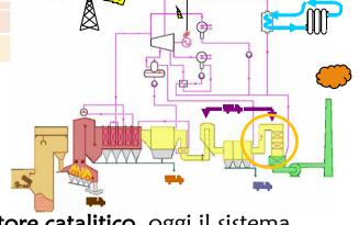
Nel reattore catalitico, oggi il sistema più efficace per ottenere bassi livelli di emissione in atmosfera, verranno rimossi più del 95% degli ossidi di azoto  $(NO_{x}).$
