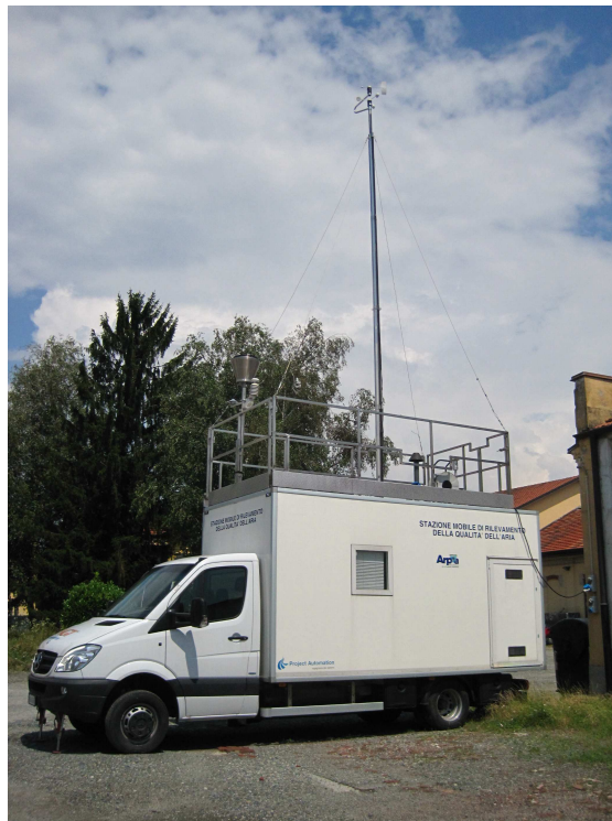
FIGURA 48: la stazione mobile di rilevamento della qualità dell'aria.
