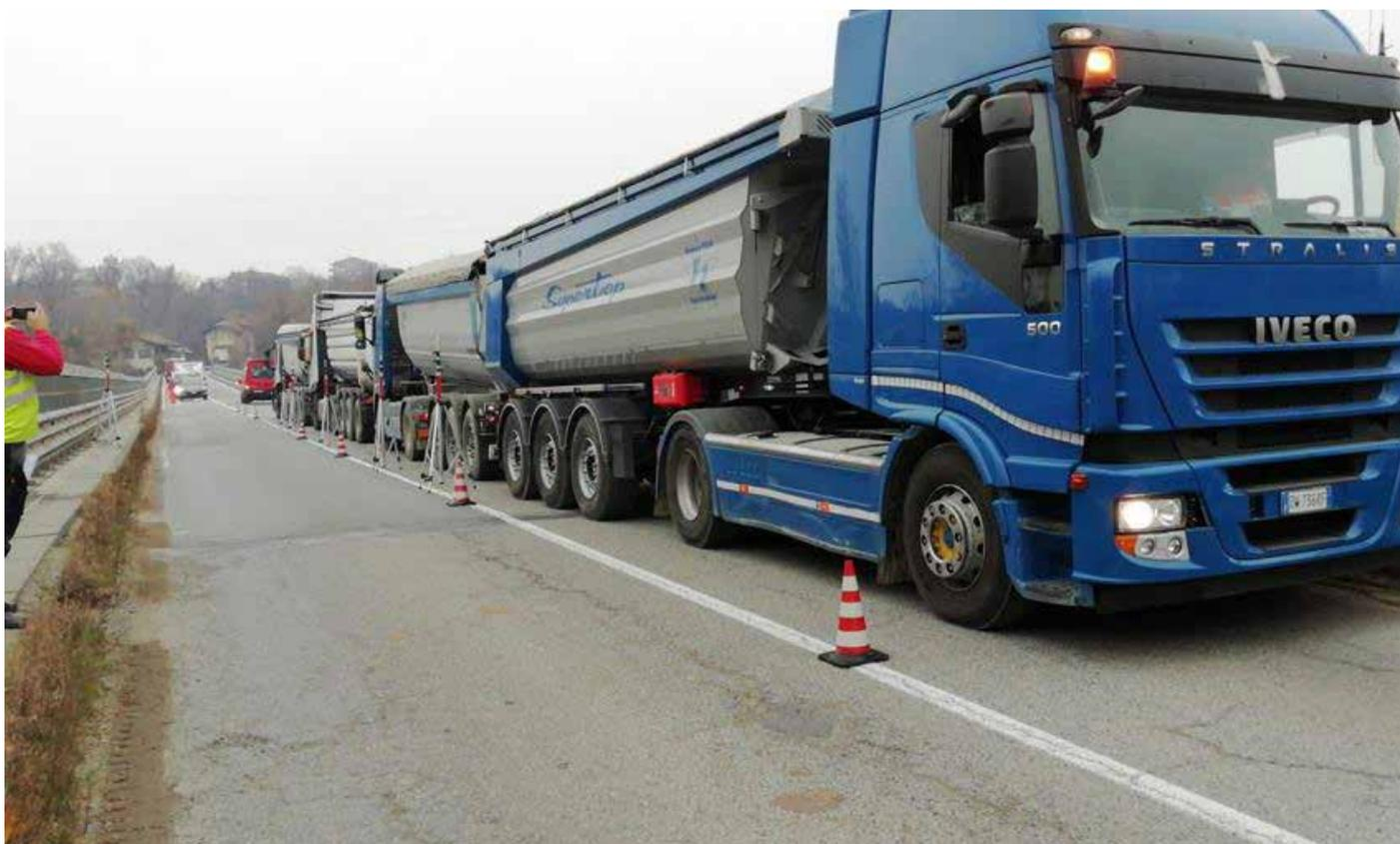
nel tempo) il traffico veicolare (a senso unico alternato) in modo da cogliere le accelerazioni prodotte dal passaggio di mezzi pesanti. Queste prevedono la collocazione di 7 accelerometri: 4 accelerometri triassiali e 3 accelerometri monoassiali. I dati trasmessi dagli accelerometri saranno gestiti e registrati da 2 centraline e relativo software di elaborazione.
