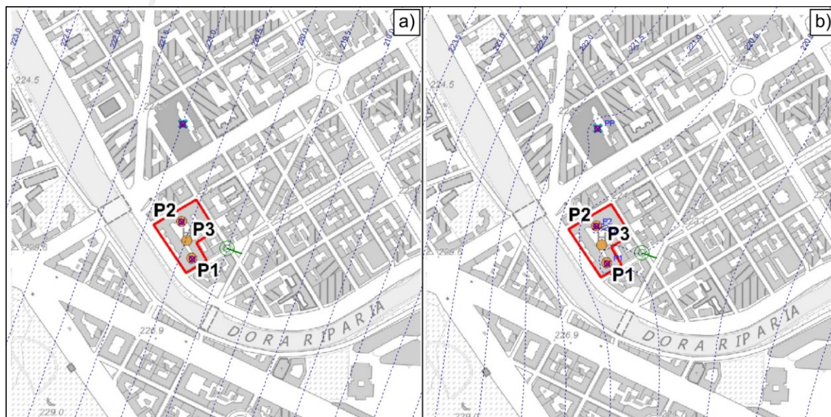
Figura z: Simulazione della piezometria della falda superficiale mediante software Whaem. a) Piezometria in assenza di pompaggio; b) Piezometria in seguito al pompaggio contemporaneo di tre pozzi.
