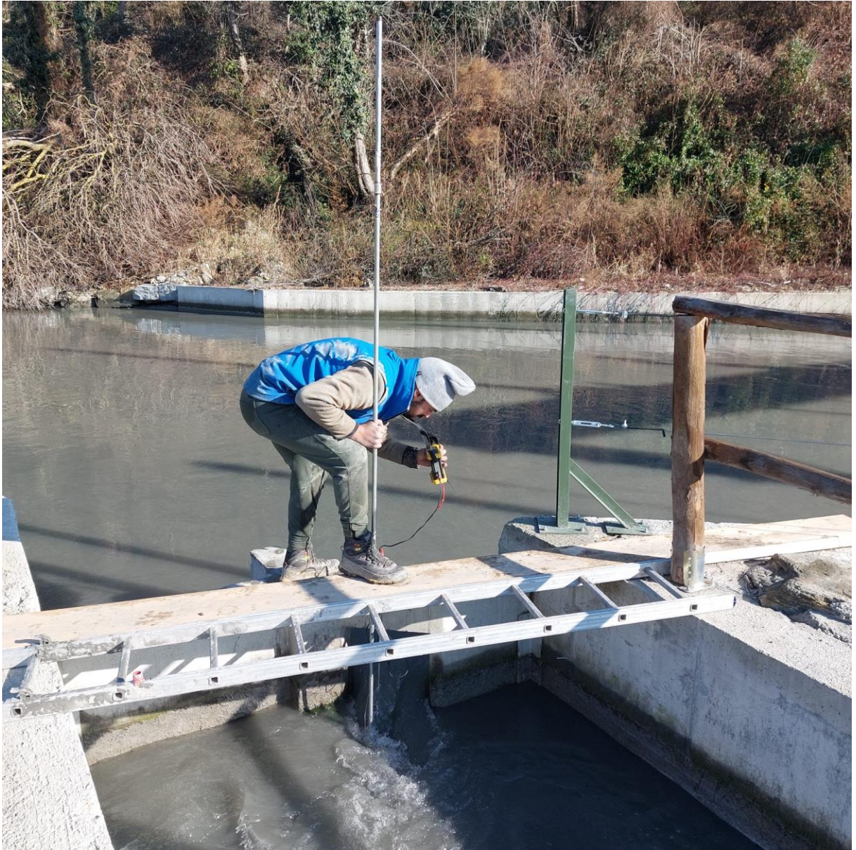
Fotografia 3: Operazioni di misura della portata
