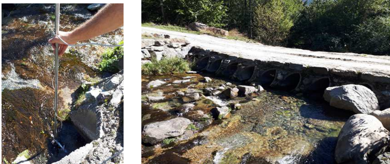
Fig. 4.7 Operazioni di rilievo delle velocità (a sinistra) e visione di insieme della sezione di misura del ponte di tubi (a destra).
